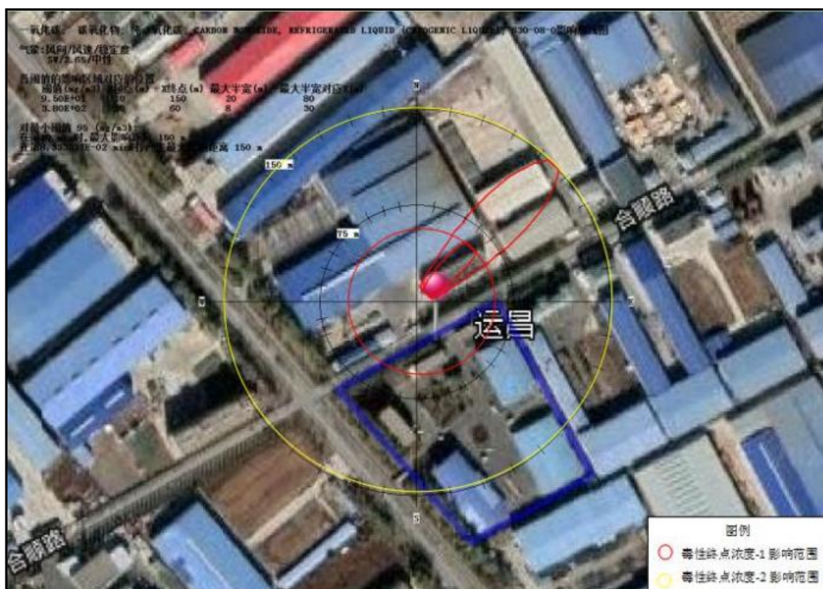
图 4-2 当地最常见气象条件下甲苯泄漏火灾事故 CO 毒性终点浓度出现的距离
